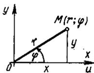
Рис.23. Связь полярных и декартовых координат
