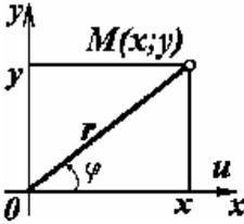
Рис. 2. Связь полярных и декартовых координат
